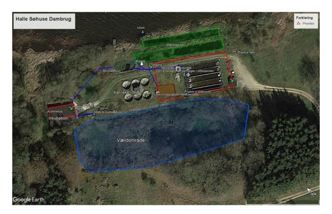
Anlæg = Outdoor broodstock facility Afsivningsplatform = Seepage pit Slambassin = slurry basin Bundfældning = sedimentation pond Kummehus = incubation and nursery Vældområde = Spring area Plante laguner = Plant lagoons Green arrow, indgang = Entrance Outlet = udløb
